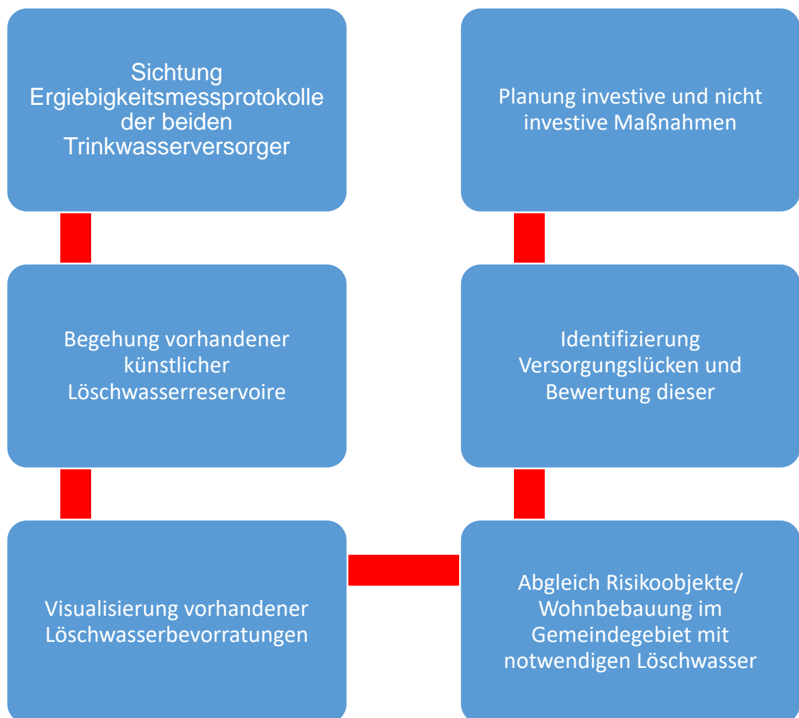
Abb. 7: Ablaufschema Sicherstellung Löschwasserversorgung
