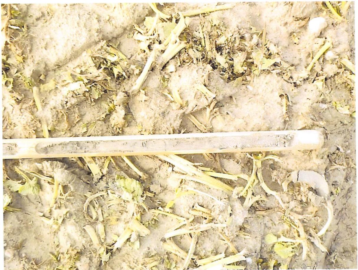
Bild 6: S-Ecke, Schluff, feinsandig, tonig, bis 4,7 m, dann Feinsand, mittelsandig, schluffig.
