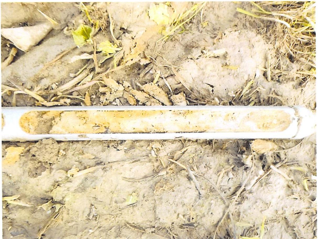
Bild 4: N-Ecke, Schluff, feinsandig, tonig, schwach kiesig, oberflächennah bei 0,5-1,0 m.
