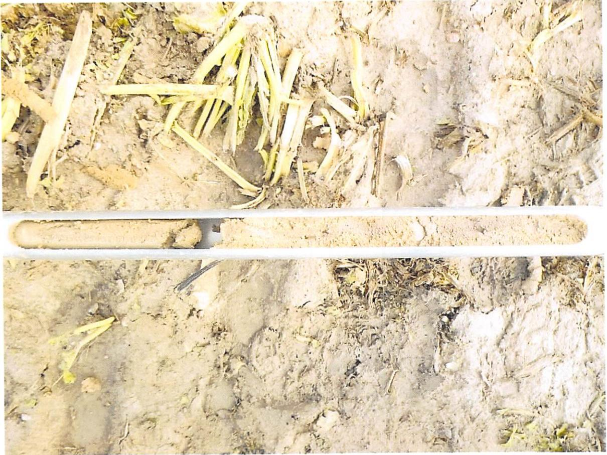
Bild 5: O-Ecke, Schluff, feinsandig, tonig, schwach feinkiesig, bei 2,5-3,0 m.
