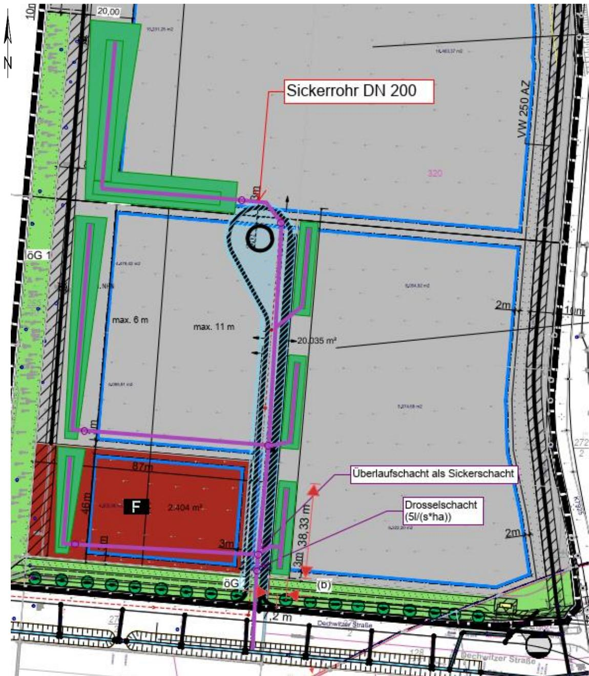
Abb. 10 Mögliche Anordnung aller Mulden-Rigolen, sowie Verbindungsleitungen
