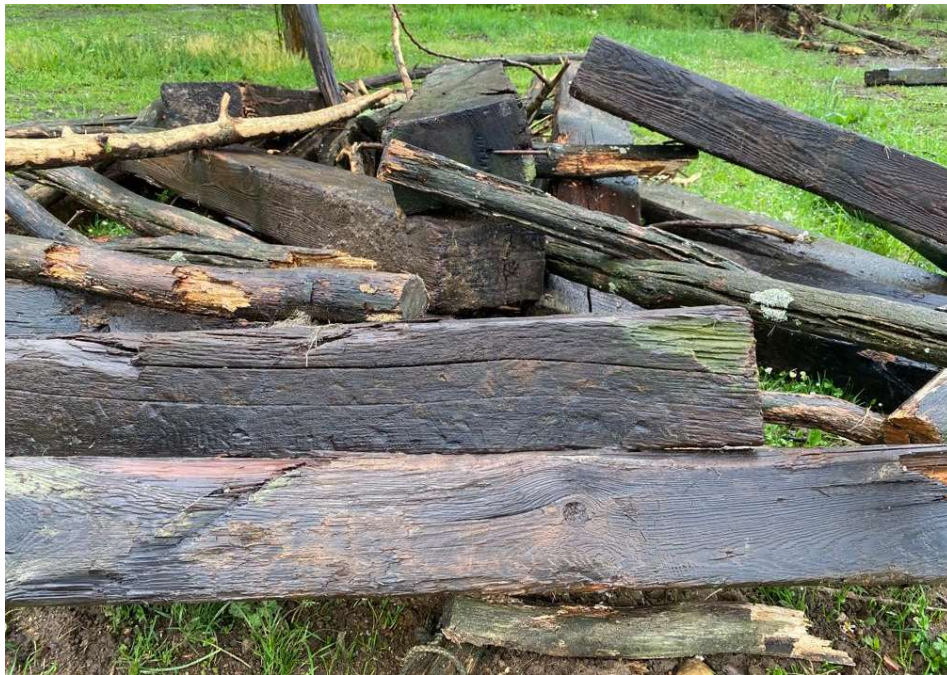
Abbildung 7: Ebenfalls auf der Fläche befindliches abgelagertes Material unter anderem kontaminierte Bahnschwellen (Quelle: C. Funke, Datum der Aufnahme: 04.05.2021)
