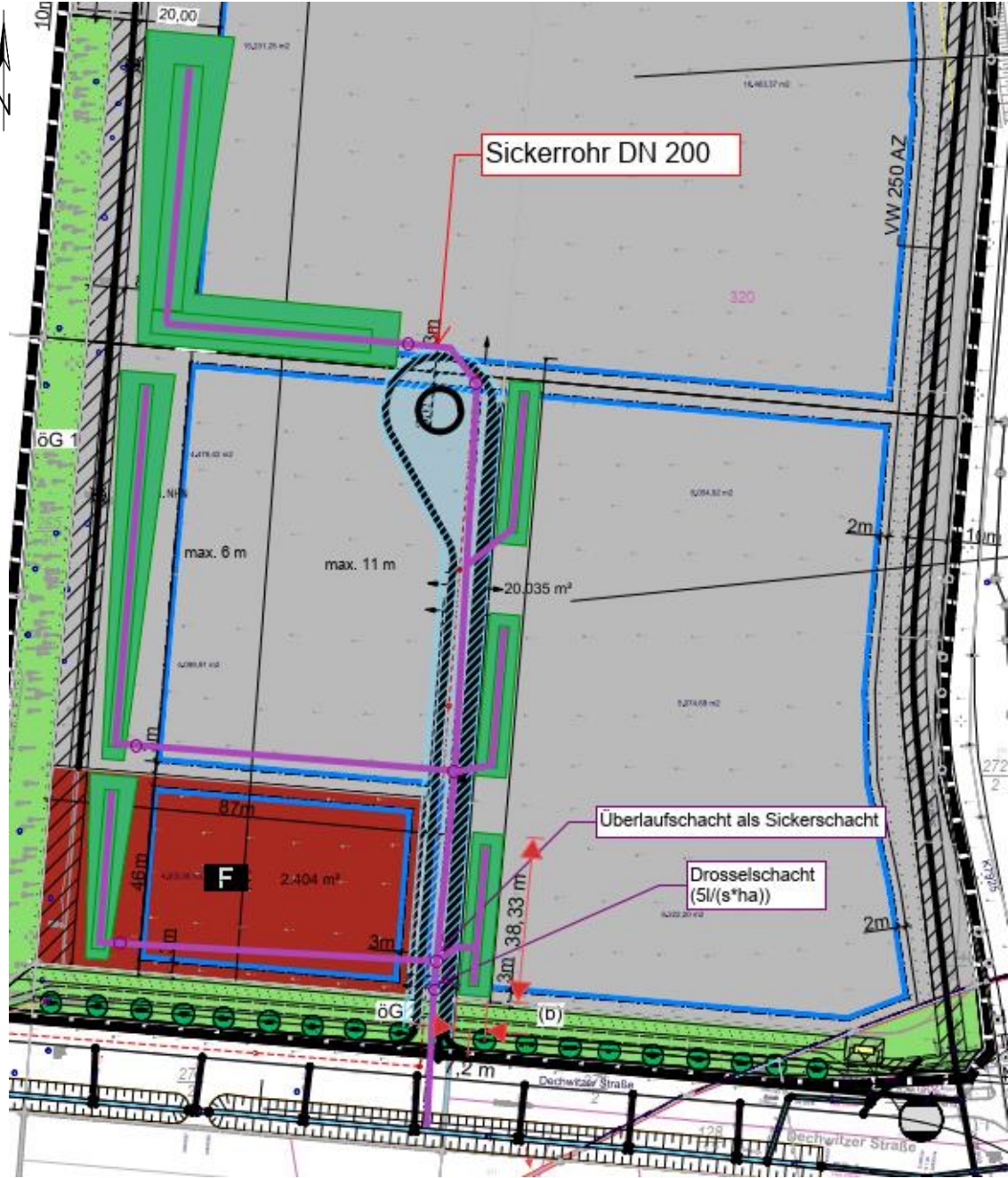
Abb. 10 Mögliche Anordnung aller Mulden-Rigolen, sowie Verbindungsleitungen
