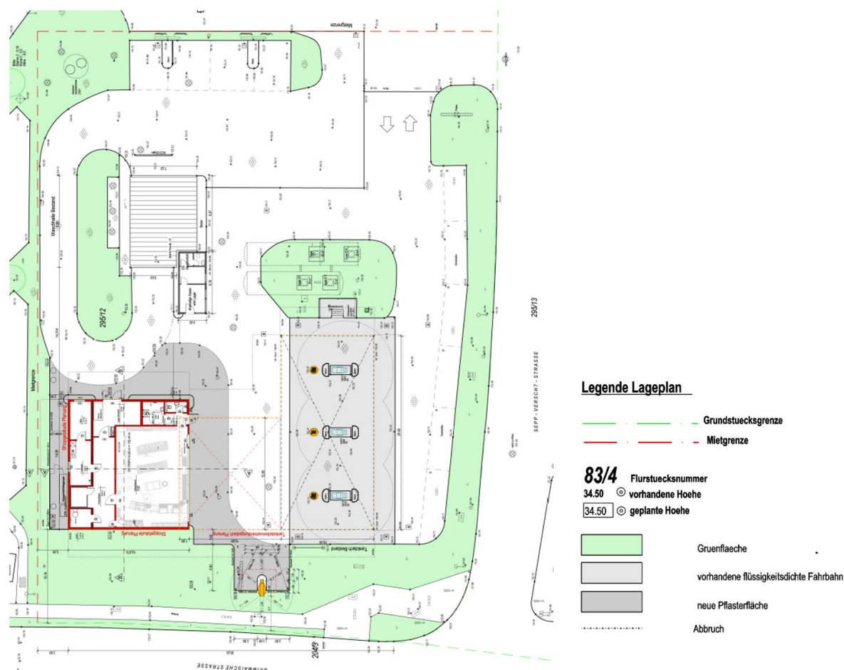
Abb. 6: Lageplan und Grundriss – Neubau Shop-Gebäude Tankstelle Großpösna 7
